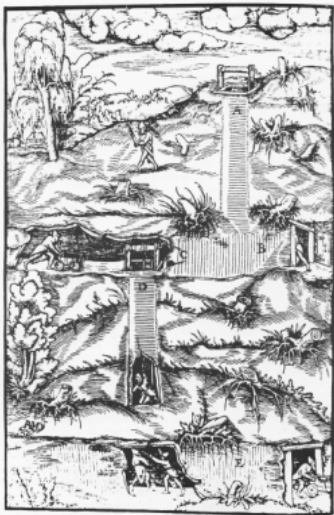
Il sistema delle gallerie di una miniera e la Discesa nelle miniere (De Re Metallica di Giorgio Agricola, 1494-1555) ( FURIA, 2000, pp.10 e 14).
