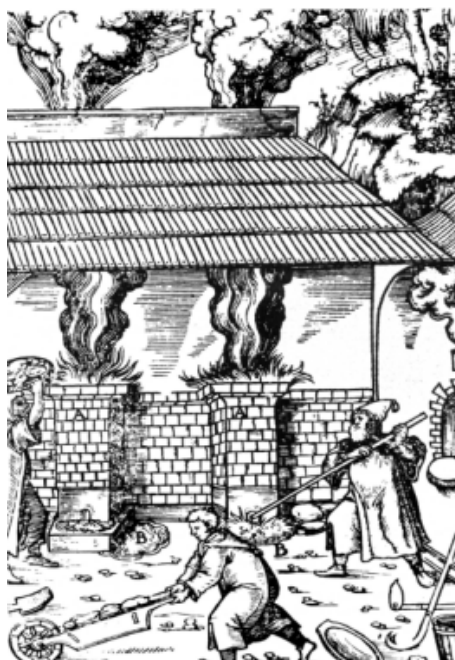
Forni di fusione del minerale (De Re Metallica di Giorgio Agricola, 1494-1555) (FURIA, 2000, p. 26).
